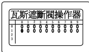
1. 當瓦斯感知器感知到有瓦斯漏氣現象監視符號0 變● 並發出警報聲
